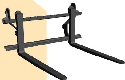
Un outil simple pour les travaux de manutention de palettes, disponible en attelage EURO uniquement, le transpalette est équipé de 2 fourches homologuées FEM 2A, permettant la manutention de palettes d'une charge maximum de 1200 kg\*. Le réglage de l'écartement des fourches s'effectue sur un tablier crénelé. L'utilisation d'un chargeur avec parallélogramme est recommandé. Cet outil nécessite l'utilisation d'un dispositif de sécurité levage / bennage sur le chargeur.
