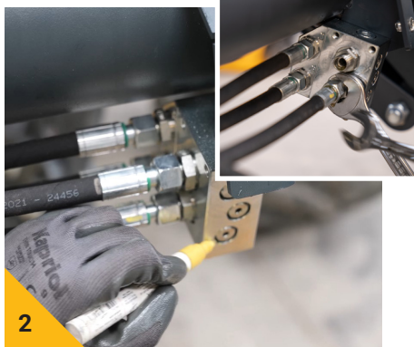
2 Repérer puis démonter les deux flexibles à gauche du bloc hydraulique.
