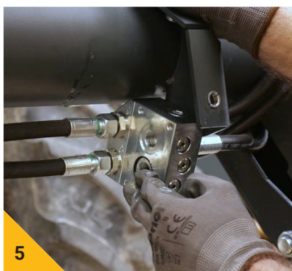
5 Placer les 2 joints toriques fournis dans le kit sur l'embase hydraulique du chargeur.
