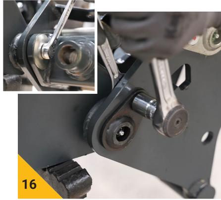
Bloquer les axes en remontant les vis de blocage, puis monter les 2 coupelles biseautées fournies dans le kit sur les axes inférieurs du cadre porte outils.
