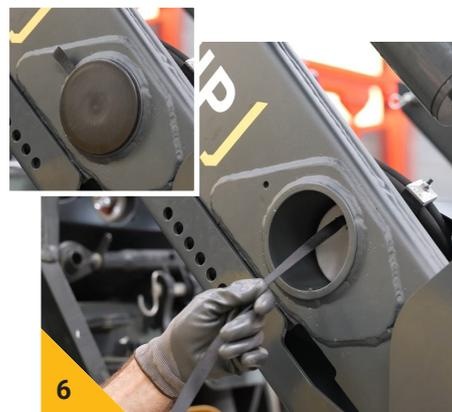
6 Faire ressortir du côté droit l'extrémité de la sangle de maintien de la glissière. Replacer le couvercle en y coinçant l'extrémité de la sangle.
