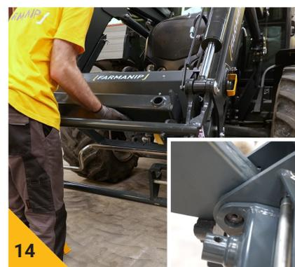
Positionner la poutre porte doigts dans le cadre porte outils.
