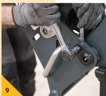
Retirer les 2 vis de blocage des axes inférieurs du cadre porte outils.
