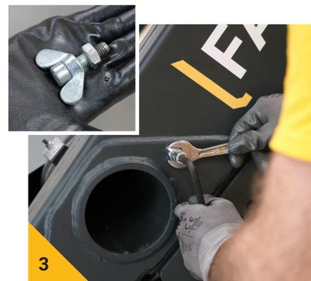
3 Assembler le verrou (vis, écrou papillon et contre écrou) comme ci-dessus, puis visser et serrer l'ensemble sur le brancard du chargeur.
