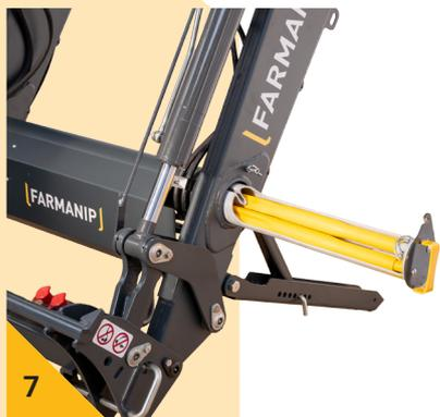
Tirer la glissière jusqu'en butée afin de vérifier le maintien de la sangle.
