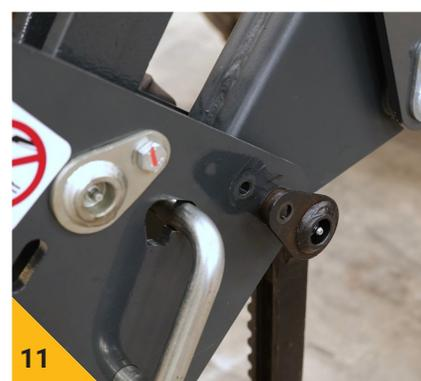
Retirer l'axe inférieur d'un côté du cadre porte outils.
