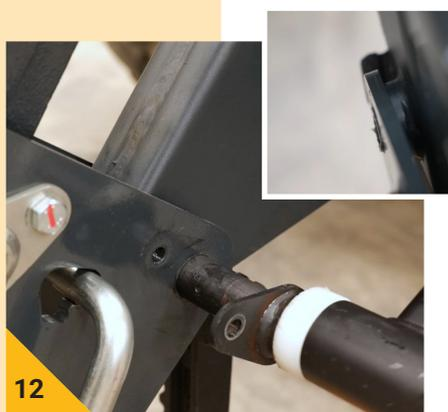
Monter l'axe plus long fourni et le prépositionner pour accueillir la poutre porte doigts.
