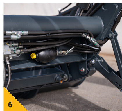
6 Ouvrir la vanne pour activer la suspension, et fermer la vanne pour la désactiver. Pour plus d'information référez-vous à la notice d'utilisation du chargeur.
