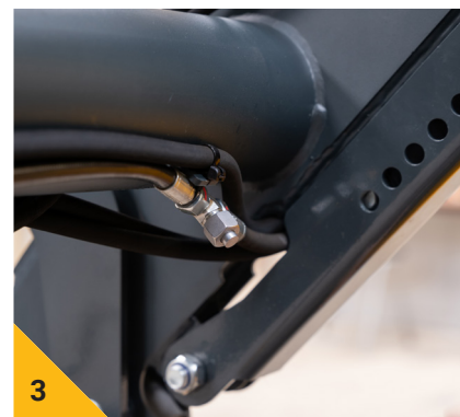
3 Placer un bac sous la traverse afin de récupérer l'huile liée au démontage. Démontez avec précaution le bouchon sur le raccord Té présent sur la ligne hydraulique de montée du chargeur, placé derrière la traverse.
