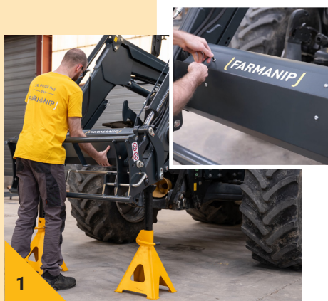
1 Démontez le carter de protection de la traverse du chargeur
