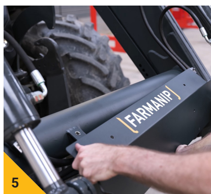
5 Remonter le carter de protection de traverse du chargeur
