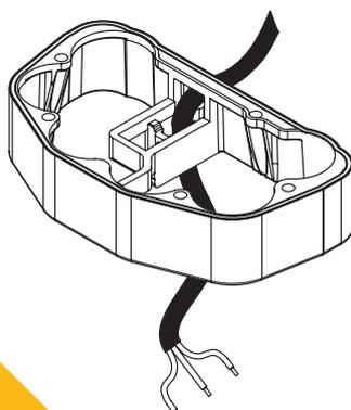
5 Si 3<sup>ème</sup> fonction hydraulique, se munir de l'ensemble jupe + couvercle MACH System fournis dans le kit, et y faire passer le faisceau à l'endroit prévu.
