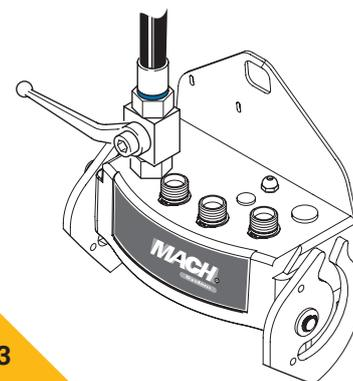
La vanne 1/4 d'origine peut être conservée entre la cloche MACH et le flexible de montée afin de verrouiller la fonction montée/descente sans déconnecter le MACH System.
