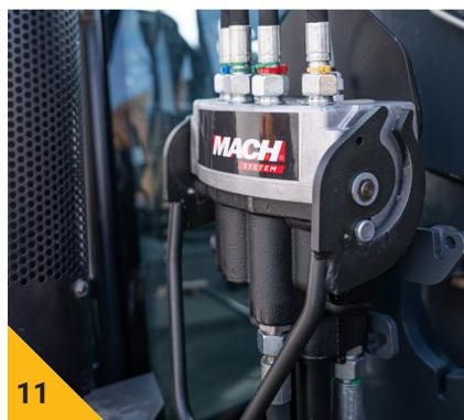
Mettre en fonctionnement le chargeur sur les fonctions montée/descente/cavage/déversement et 3<sup>ème</sup> fonction, afin de contrôler le bon fonctionnement et l'absence de fuites.
