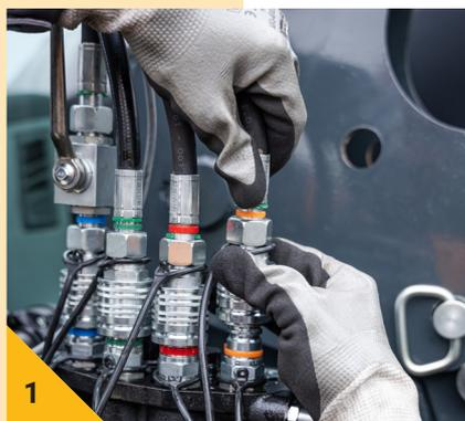
Déconnecter les 4 raccords hydrauliques push/pull.
