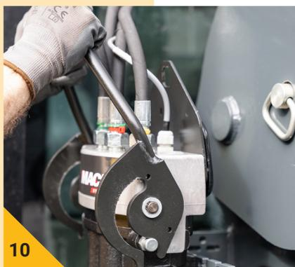
Connecter la cloche MACH System sur son socle côté tracteur (distributeur à câble ou origine tracteur).
